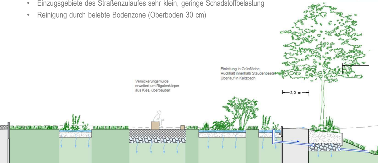
Schnitt multifunktionale Retentionsfläche, Notüberlauf in Kaitzbach
