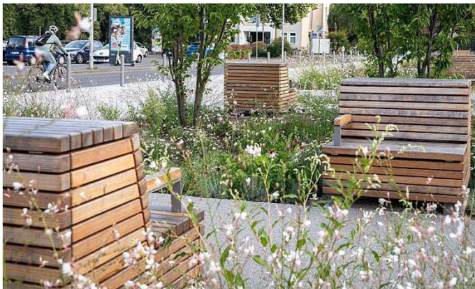
Umfeld Stadthalle Göttingen – multifunktionale Retentionsflächen, bepflanzen Versickerungsmulden in Bereichen mit hoher Aufenthaltsqualität
