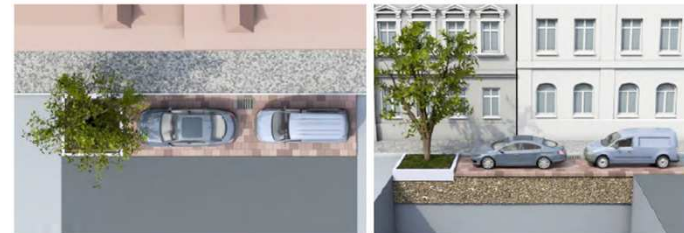
Abbildung 1: Variante 1 - Schwammstadt im Bereich von gering-teildurchlässigen Park- und Gehwegflächen; mittlerer Abflussbeiwert C_{\text{m}} 0,65 (Quelle: Leipziger Wasserwerke)
