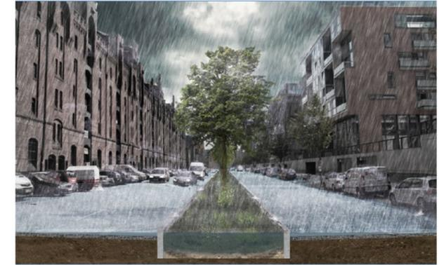
Abb. 41: Beispiellösung A - Entwässerung über Versickerungsmulde im Mittelstreifen
