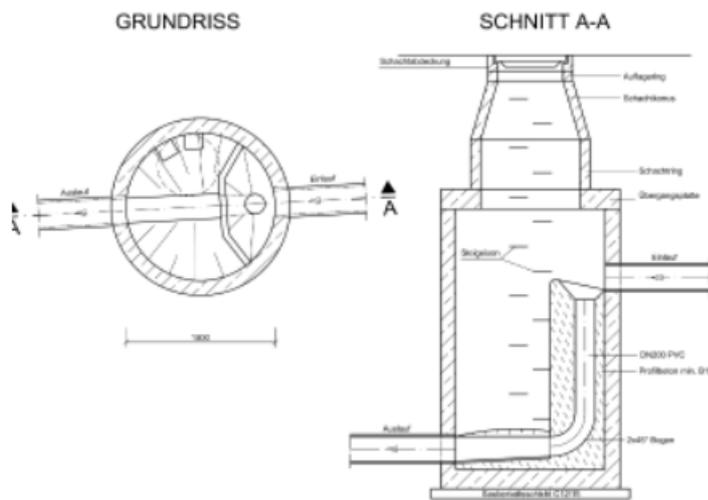
Abbildung 12: Schacht mit innenliegendem Absturz
