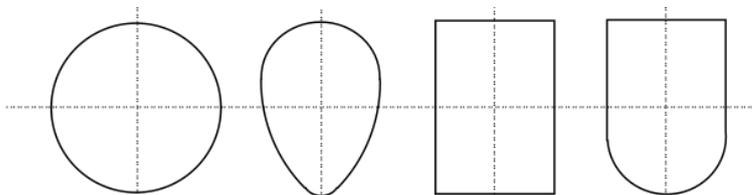
Abbildung 3: Definition des Querschnittsmittelpunktes (in Anlehnung an [2])
