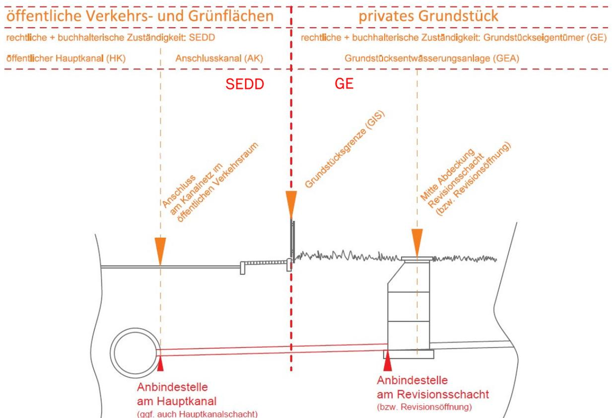
Abbildung 1: Abgrenzung Hauptkanal, Anschlusskanal, Grundstücksentwässerung
