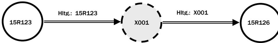
Abbildung 8: Beispiel Nummerierung für einen aufgefundenen Zwischenschacht
