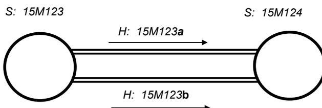
Abbildung 10: Beispiel Nummerierung von parallelen Haltungen
