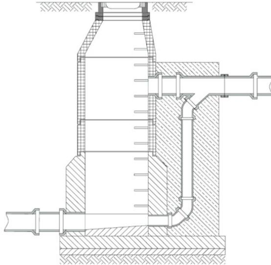
Abbildung 13: Schacht mit außen liegendem Absturz
