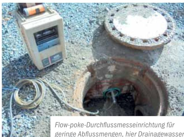
Flow-poke-Durchflussmeseinrichtung für geringe Abflussmengen, hier Drainagewasser
