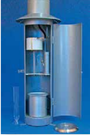
Regenmesser nach Hellmann mit mechanischem Schreiber
