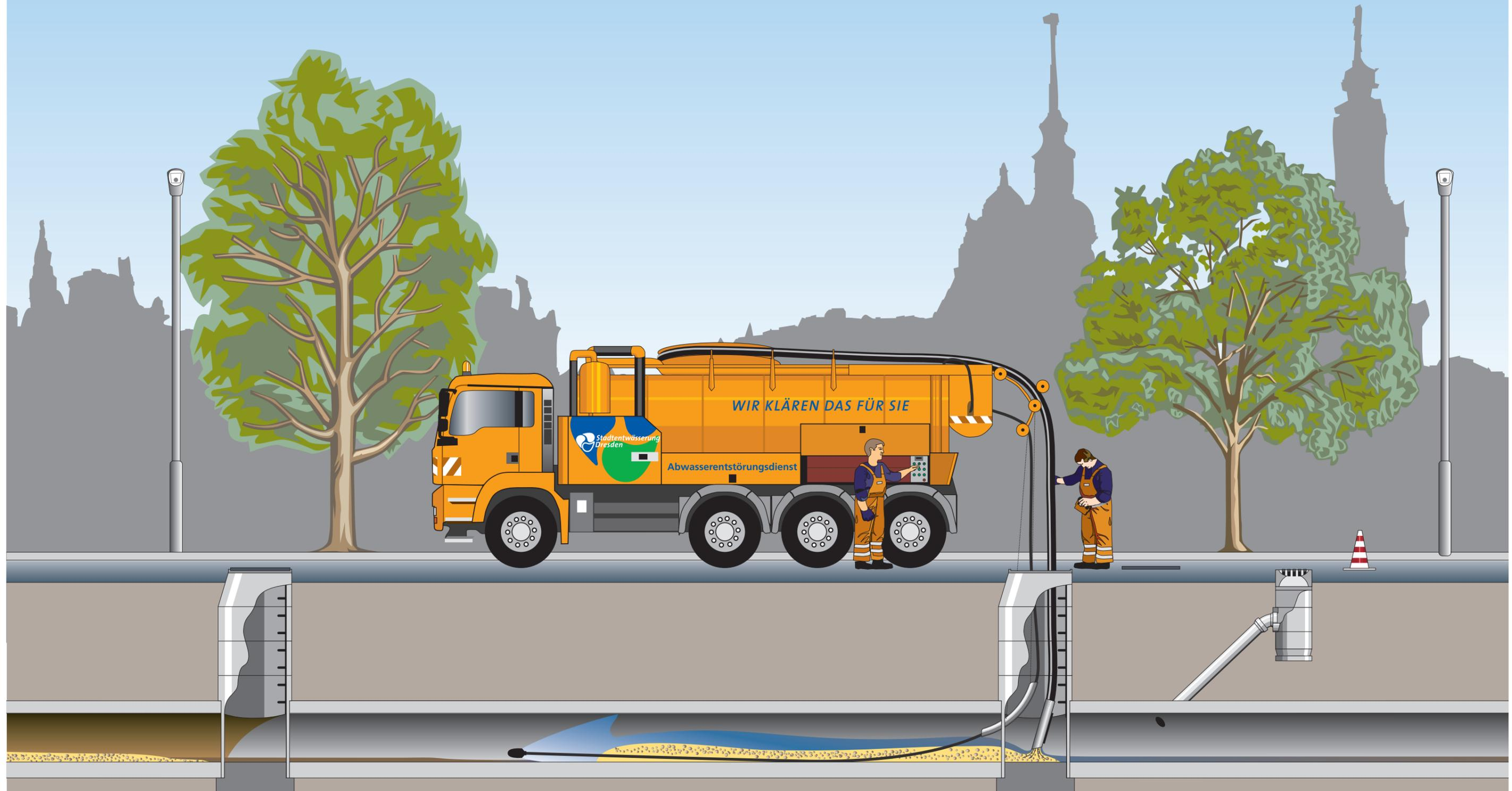
Kanalreinigung mit modernem Saug- und Spülfahrzeug: Mit hohem Druck wird Wasser in den Spülkopf gepumpt. Durch die Umlenkung entsteht ein Vortrieb, der Schlauch wird in den Kanal gezogen – anschließend zurückgeholt. Sowohl im Vorwärts- als auch im Rückwärtsgang werden die Kanalwände gereinigt. Die weggespülten Ablagerungen werden in das Fahrzeug gesaugt, der Schmutz herausgefiltert und das Wasser erneut verwendet.
