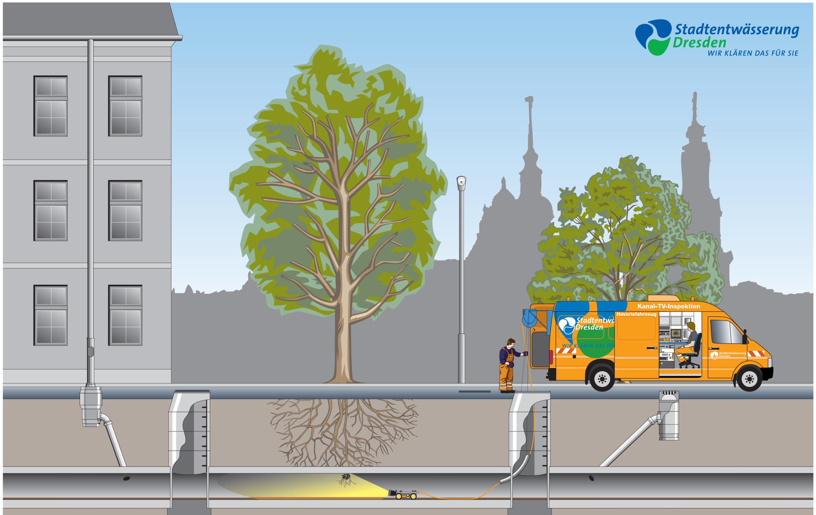
Wenn der Kanal gereinigt wurde, kann anschließend eine Befahrung mit der Videokamera erfolgen, um z. B. Schäden aufzuspüren. Die ferngesteuerten Roboter verfügen über eine schwenkbare Kamera, die Live-Bilder an den Monitor im Fahrzeug sendet. Die Ergebnisse der Kanal-TV-Befahrungen werden im elektronischen Netz-Informationssystem erfasst.
