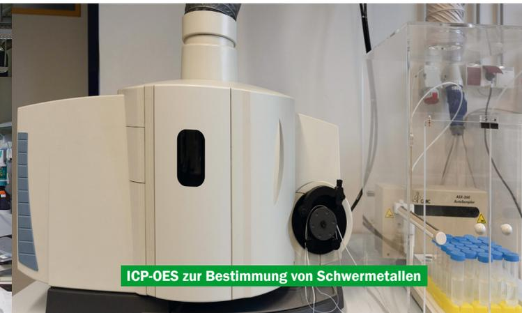
ICP-OES zur Bestimmung von Schwermetallen
