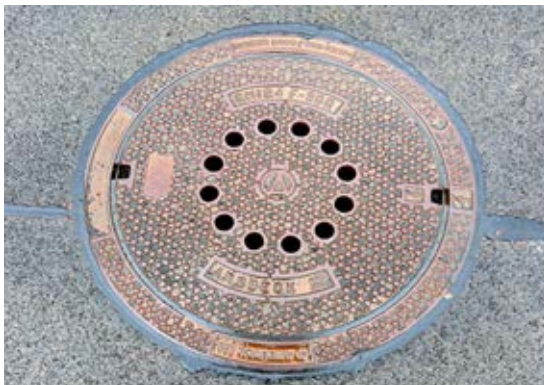
F 900 Abdeckung, mit Federarretierung (Amsbeck) → Bauhöhe 12,5 cm
