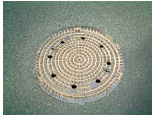
D400 Abdeckung Vollguss (Telekap) → Bauhöhe 20 cm bis 27 cm über Schrauben höhenverstellbar
