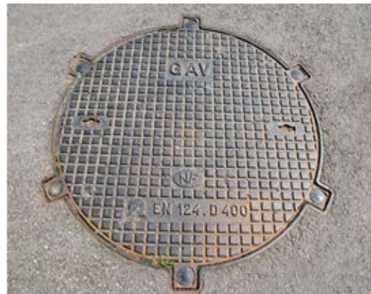
400 Abdeckung Vollguss verschraubt mit Aushebeöffnungen → Bauhöhe 11 cm
