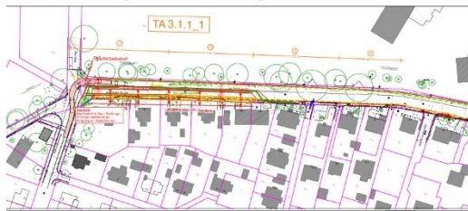
Phase 1 - Leitungsbau südl. Gehweg
